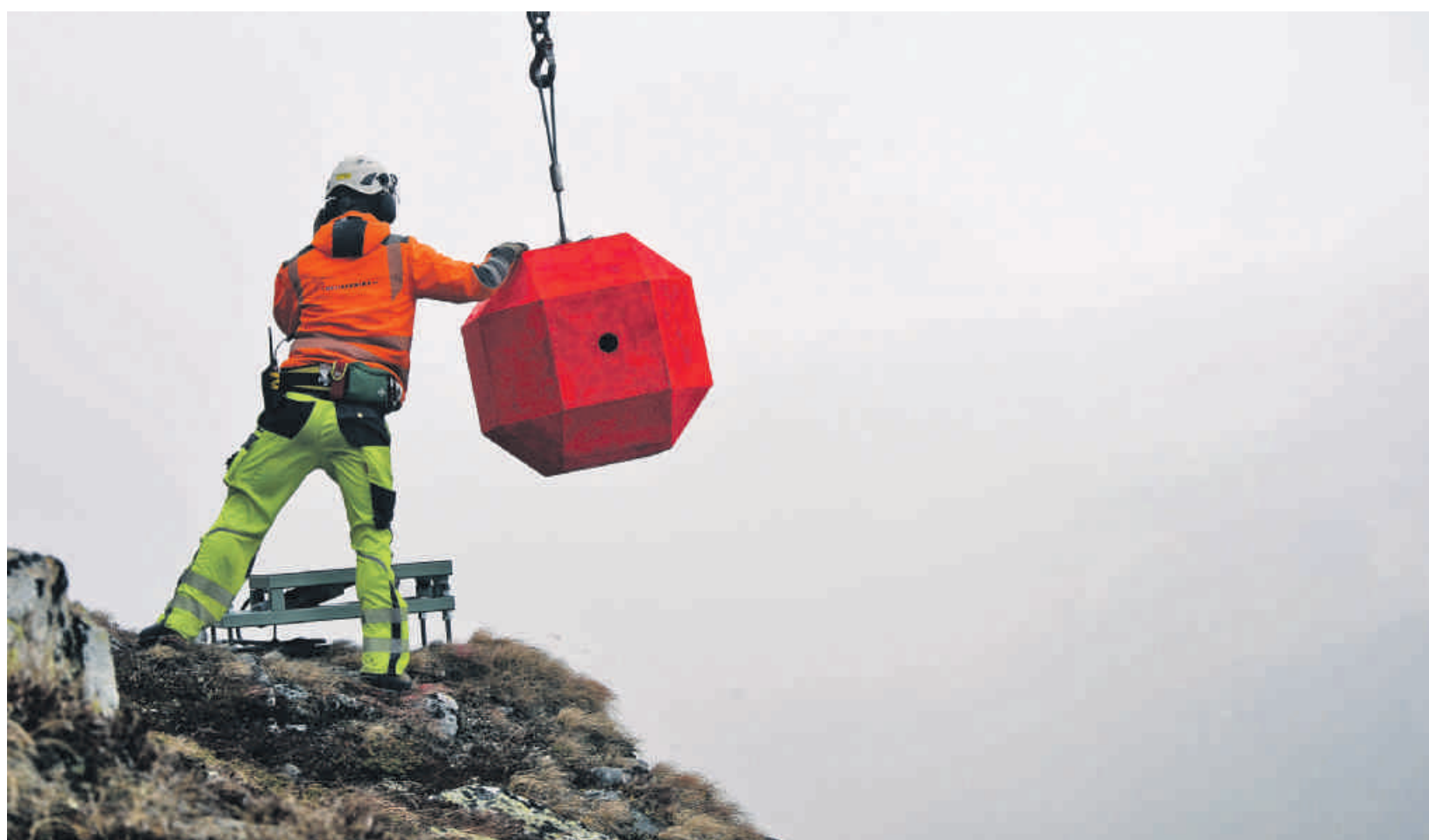
Vorbereitungen für das Steinschlag-Experiment des WSL-Instituts für Schnee- und Lawinenforschung.
